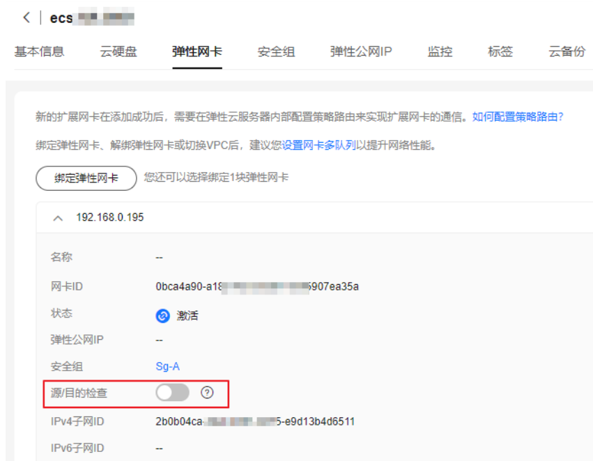
图 2-3 关闭网卡的“源/目的检查”功能
