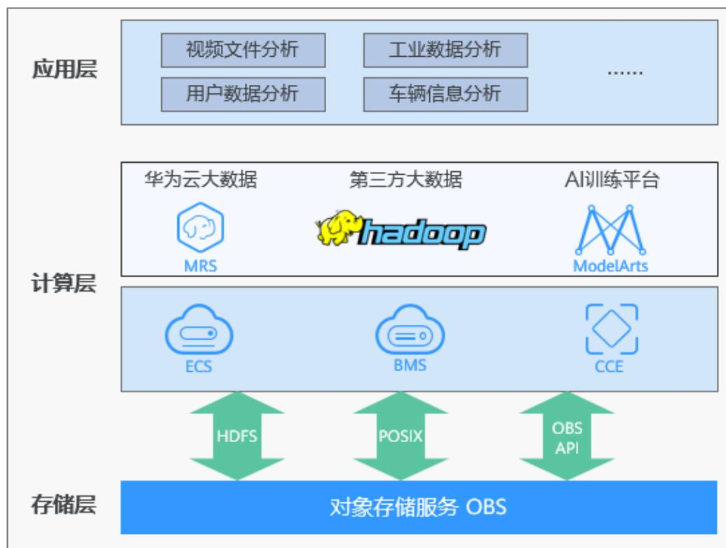
华为云大数据存算分离方案基于对象存储服务OBS的大容量高带宽能力，以及多协议共享访问技术（HDFS/POSIX/OBS API），实现Hadoop生态多计算引擎（Hive、Spark等）兼容对接。
