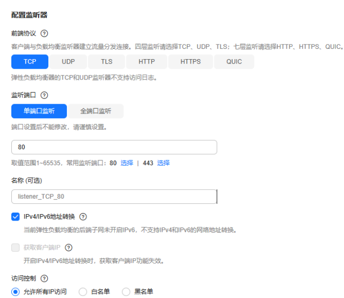
图 4-25 添加 TCP 监听器并开启“IPv4/IPv6 地址转换”
