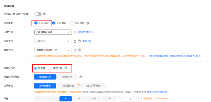
图 2-8 为负载均衡器配置弹性公网 IP
