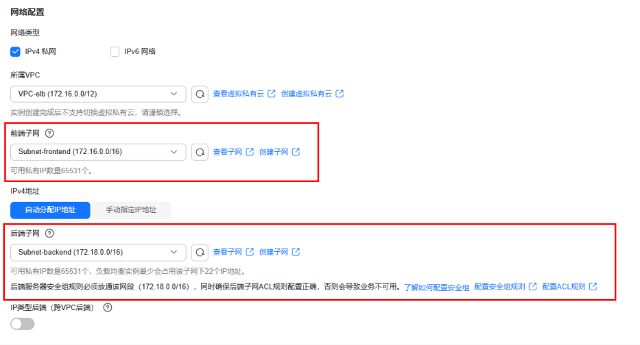
图 1-2 独享型负载均衡器的网络配置
