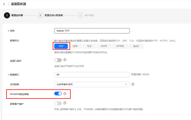
图 4-25 添加 TCP 监听器并开启“IPv4/IPv6 地址转换”
