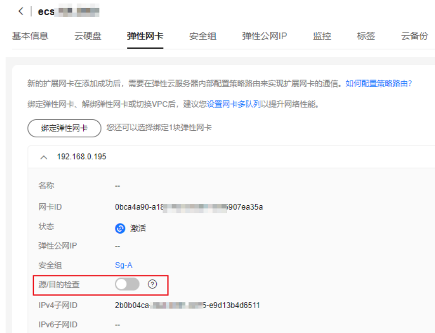
图 7-10 关闭网卡的“源/目的检查”功能
