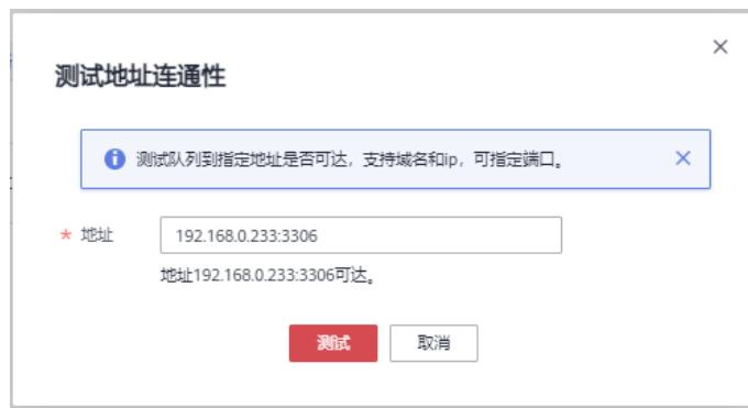
如果测试结果不可达，需要修改实例所在VPC的安全组规则，放开9092、3306端口对DLI队列的限制，DLI队列网段信息可以在队列的详情页中获取。
