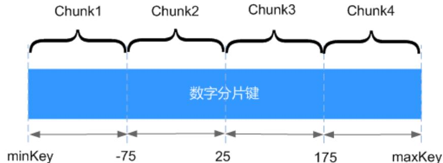
如上图所示，`x`表示范围分片的片键，`x`的取值范围为 $[minKey, maxKey]$ ，且为整型。将整个取值范围划分为多个chunk，每个chunk（通常配置为64MB）包含其中一小段的数据。其中，`chunk1`包含`x`值在 $[minKey, -75]$ 中的所有文档，每个chunk的数据都存储在同一个分片上，每个分片可以存储多个chunk，并且chunk存储在分片中的数据会存储在config服务器中，mongos也会根据各分片上的chunk的数据自动执行负载均衡。
