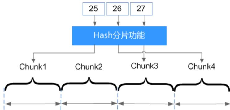
Hash分片与范围分片互补，能将文档随机分散到各个chunk，充分扩展写能力，弥补范围分片的不足。但所有的范围查询要分发到后端所有的分片，才能获取满足条件的文档，查询效率低。
