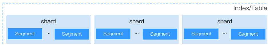
如图2-3所示，将文档插入Elasticsearch时，文档首先会被写入缓冲区Buffer中，同时写入日志Translog中，然后在刷新时定期从该缓冲区刷新文档到Segment中。刷新频率由refresh\_interval参数控制，默认每1秒刷新一次。更多写入性能相关的介绍请参见Elasticsearch的官方介绍[Near Real-Time Search](#)。
