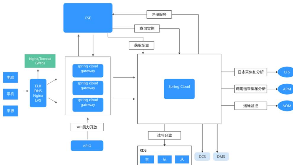
该架构采用静态页面和服务分离，这样静态页面可以灵活的使用CDN、Nginx等形态部署。spring cloud gateway屏蔽了内部微服务的结构，一般会搭配流量控制、安全认证等服务治理策略，使得内部服务能够灵活的进行拆分合并，降低内部服务直接面对流量攻击的风险。
