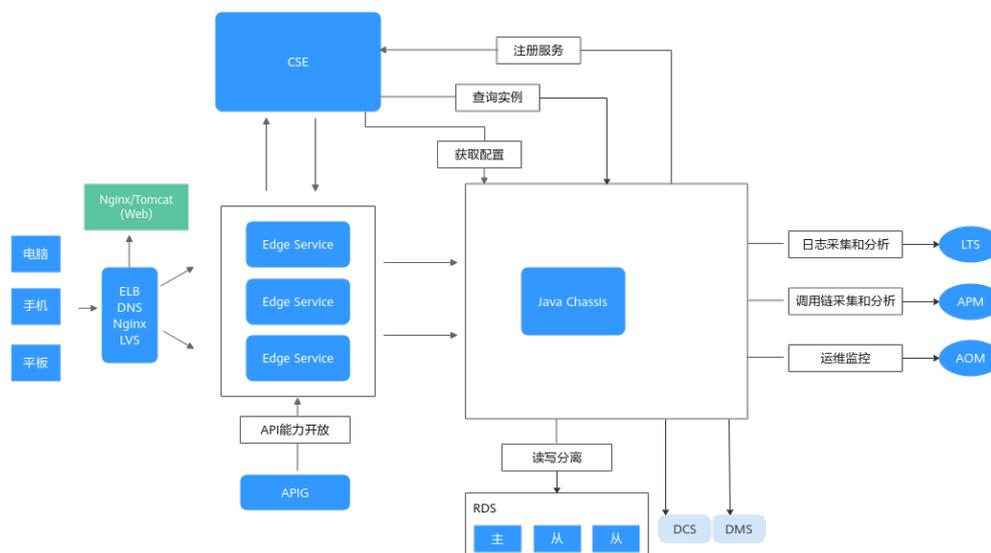
该架构采用静态页面和服务分离，这样静态页面可以灵活的使用CDN、Nginx等形态部署。Edge Service屏蔽了内部微服务的结构，一般会搭配流量控制、安全认证等服务治理策略，使得内部服务能够灵活的进行拆分合并，降低内部服务直接面对流量攻击的风险。
