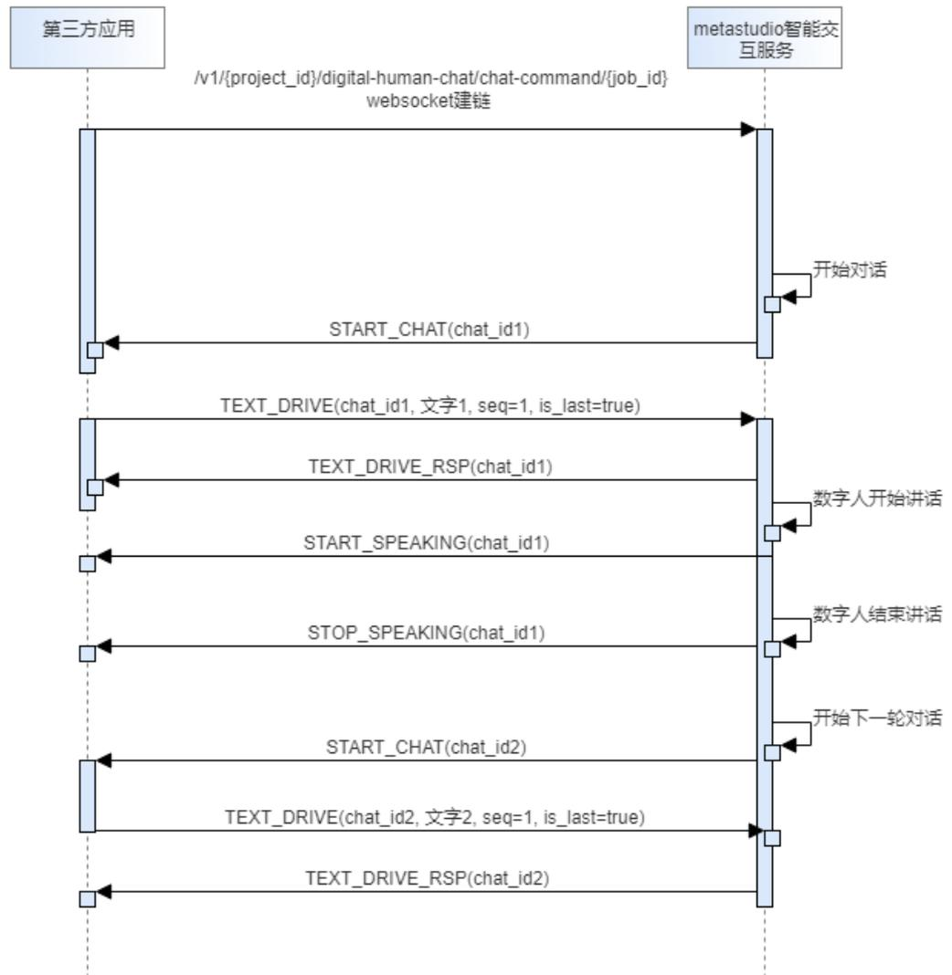
图 7-2 智能交互流式驱动流程图
