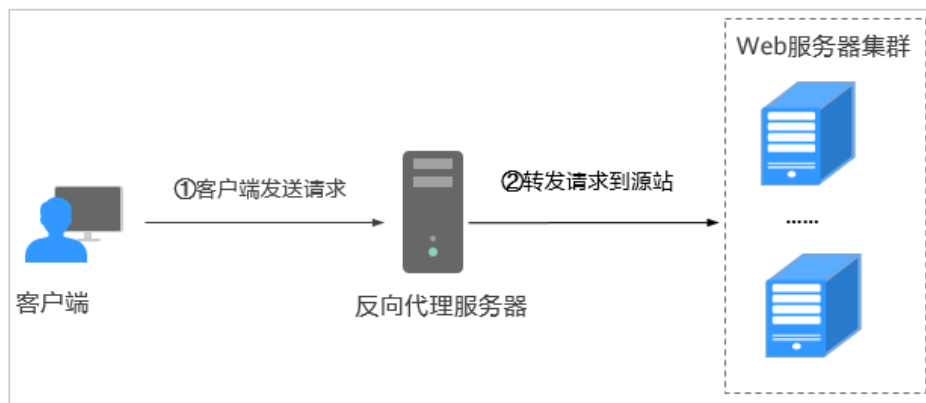
图 13-3 Nginx 转发原理
