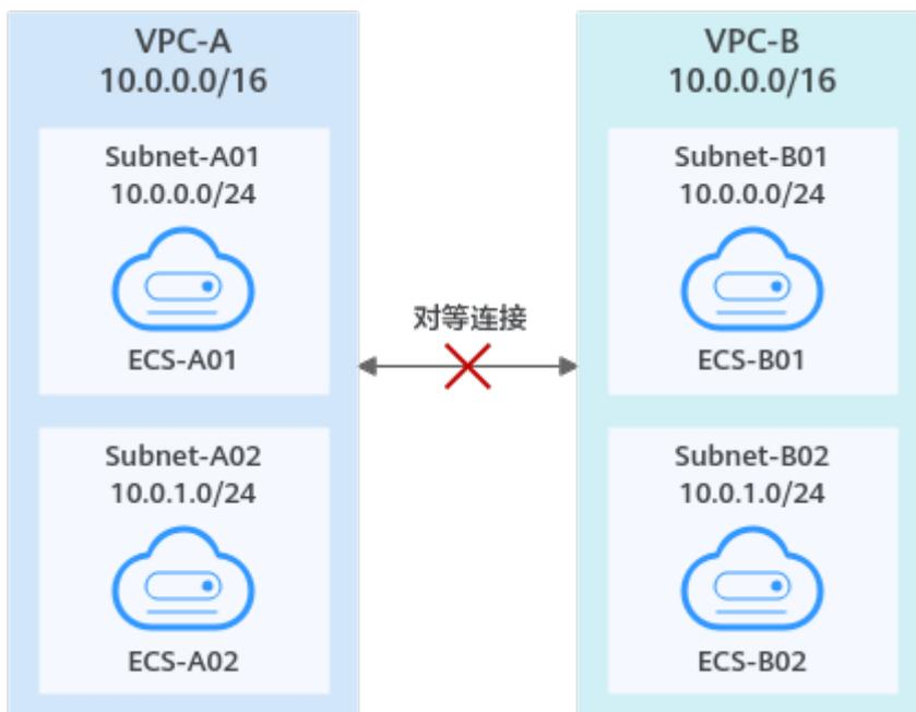
图 13-5 VPC 网段重叠，且部分子网重叠(IPv4)
