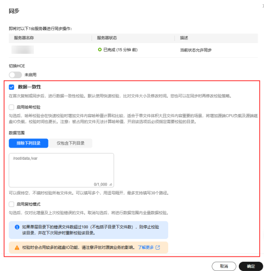
图 4-1 增量同步时启用数据一致性校验
