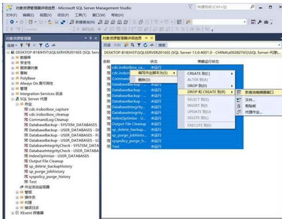
**步骤3** 复制新窗口中的T-SQL创建脚本到新实例上，然后注意修改如下几个关键项，以保障你的创建成功。
