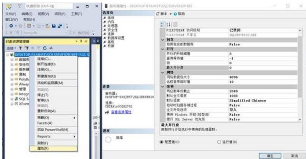
登录本云实例控制台，在实例管理页，单击目标实例名称，进入基本信息页签，切换至“参数修改”，搜索最大并行度（max degree of parallelism）并进行修改。
