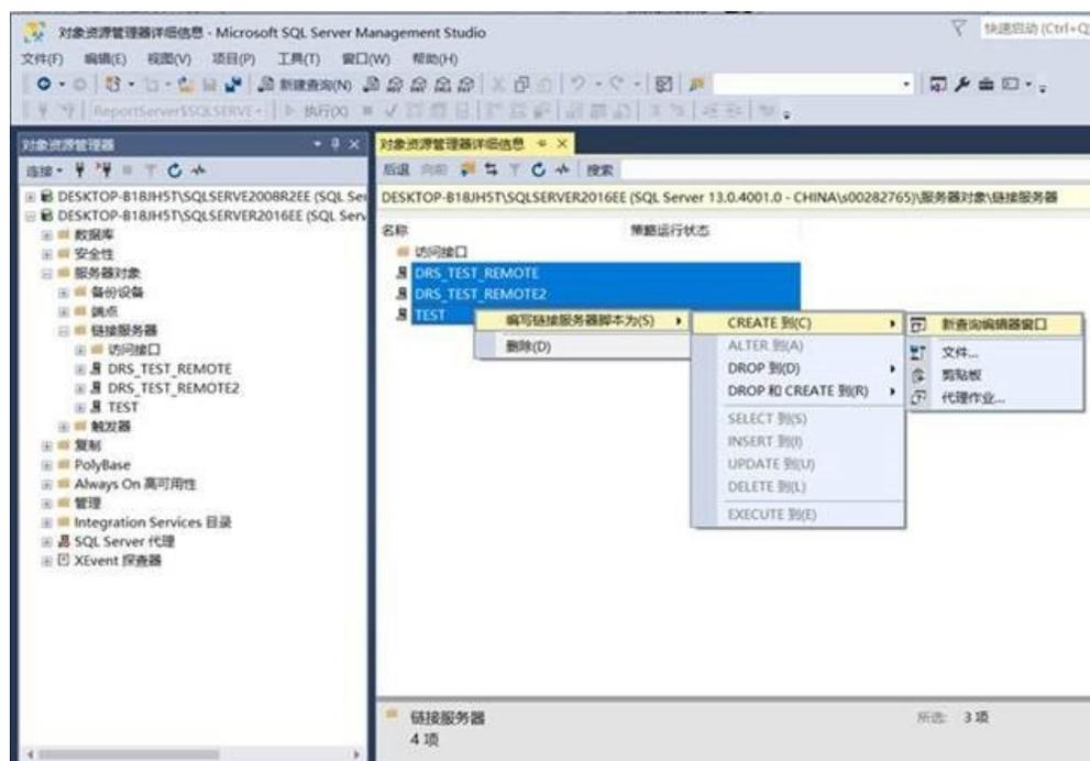
**步骤3** 在新窗口中，可以看到当前实例上所有DBLink的创建脚本，仅需复制该脚本到目标实例上，并修改@rmtpassword上的密码即可执行创建操作。
