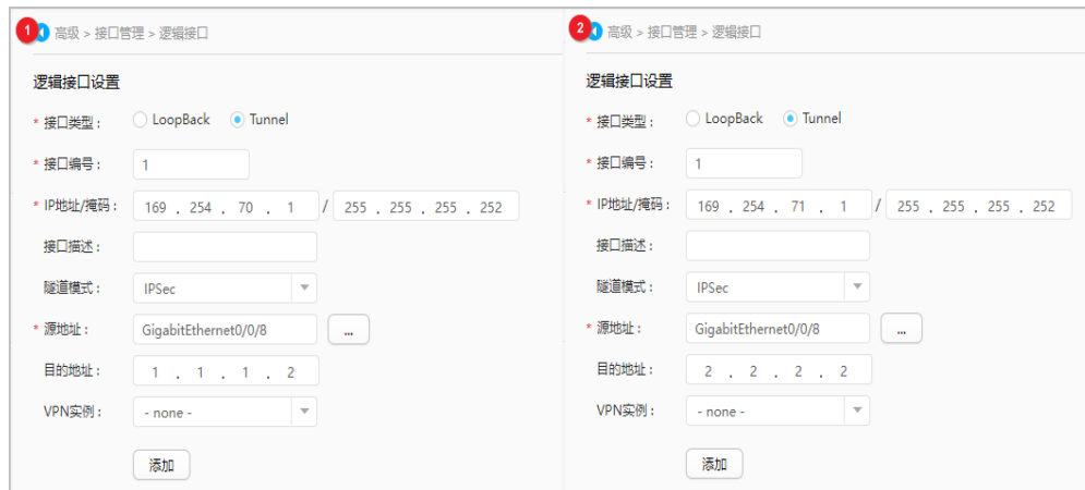
图 1-6 tunnel 接口配置
