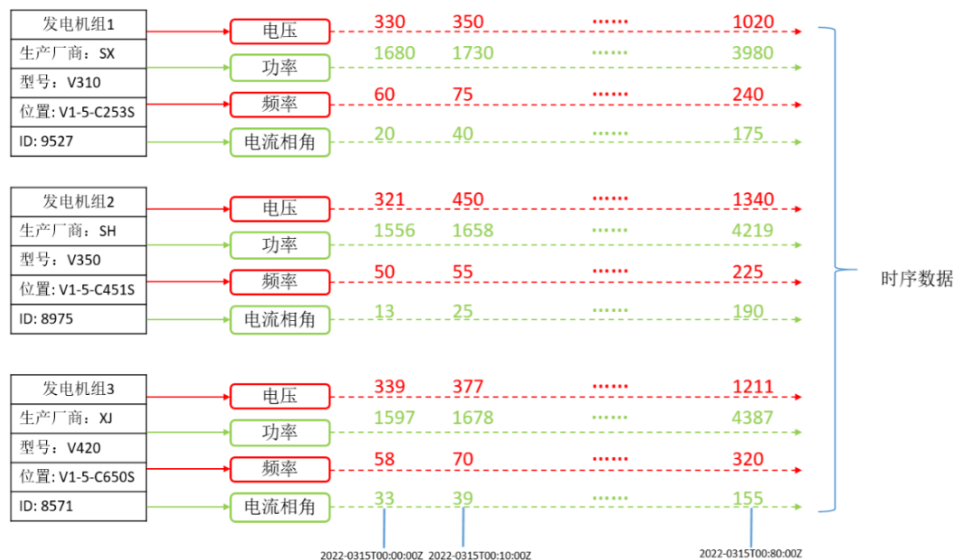
图 1-1 发电机组数据采样示意图
