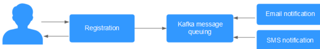
Figura 4-2 Registro assíncrono e notificação usando filas de mensagens
