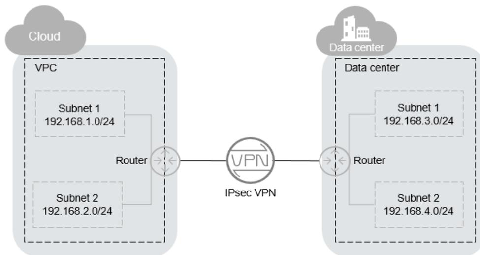
Huawei Cloud admite la VPN de sitio a sitio para permitir la comunicación entre subredes de VPC y subredes de centros de datos locales. Antes de establecer una VPN IPsec, asegúrese de que el centro de datos local donde se va a establecer la VPN cumple las siguientes condiciones:
