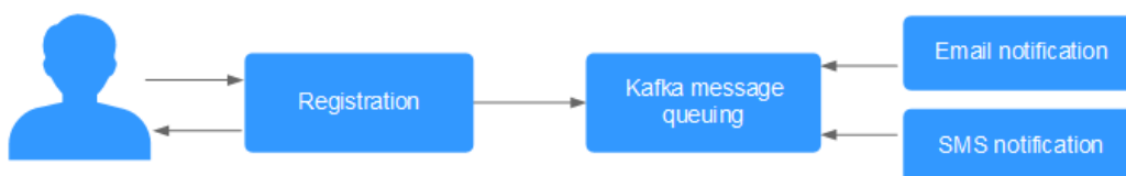
Figura 3-2 Registro asíncrono y notificación por colas de mensajes
