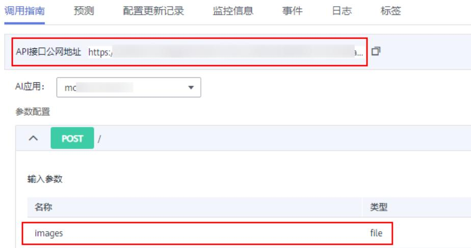
图 3-10 获取在线服务 API 接口地址和文本预测输入参数信息
