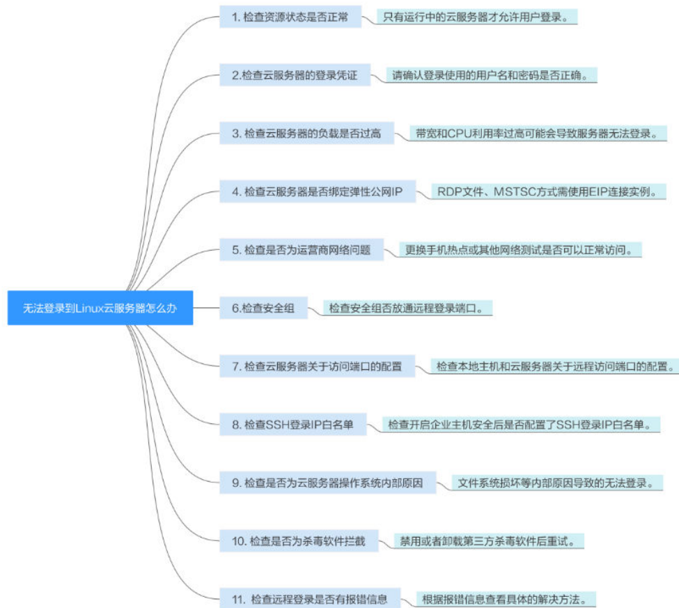
图 4-7 无法连接 Linux 实例排查思路
