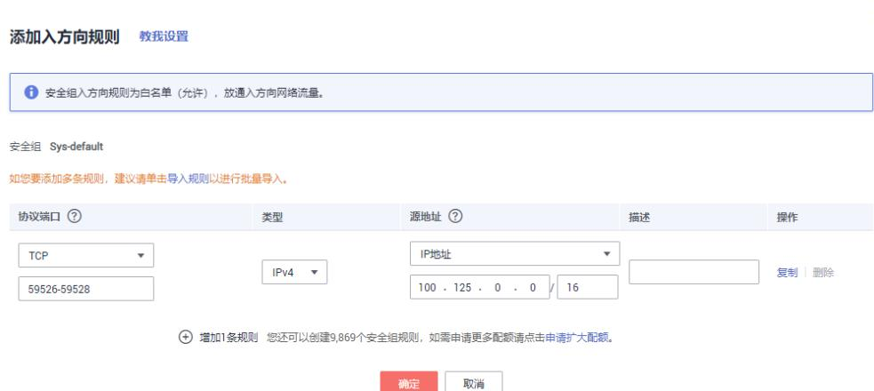
**步骤5** 选择“出方向规则”页签，单击“添加规则”，弹出“添加出方向规则”对话框，如图5-14所示。选择“TCP”协议，在“端口”中输入“1-65535”，在目的地址中选择“IP地址”，输入“100.125.0.0/16”。适当补充描述后，单击“确定”，完成出方向规则设置。
