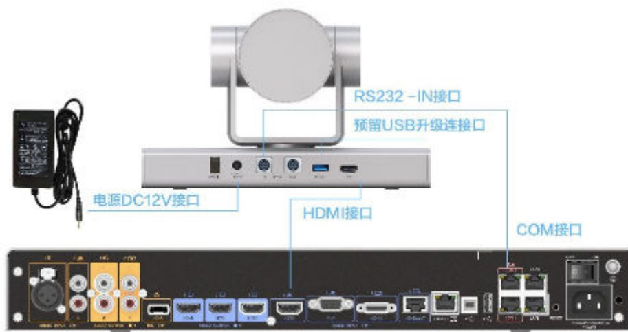
图 5-2 HDMI 线缆直连
