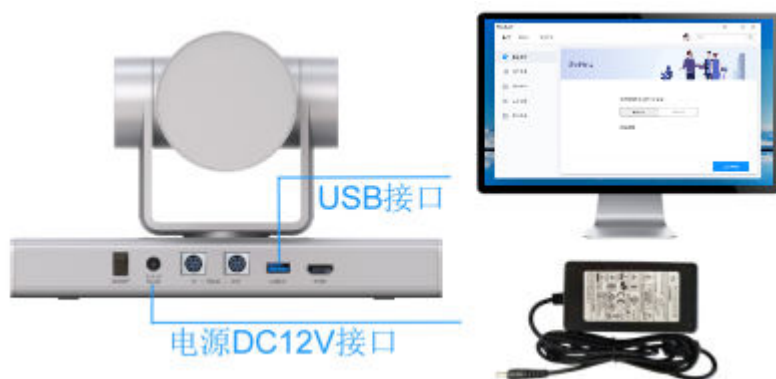
图 5-1 连接 Camera 200 和 华为云会议客户端
