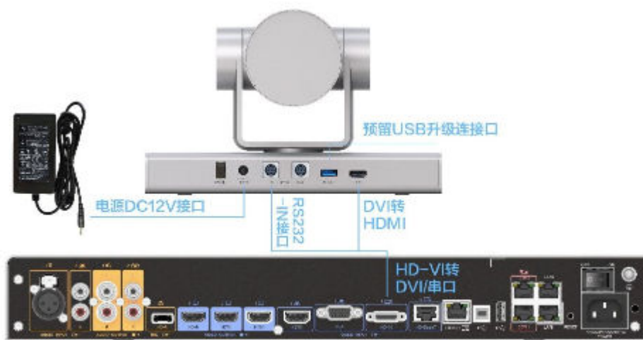
图 5-3 HDMI 线缆转接
