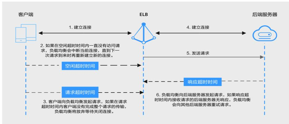
图 6-2 四层监听器超时时间示意图
