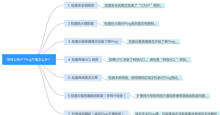
图 5-8 弹性公网 IP Ping 不通排查思路
