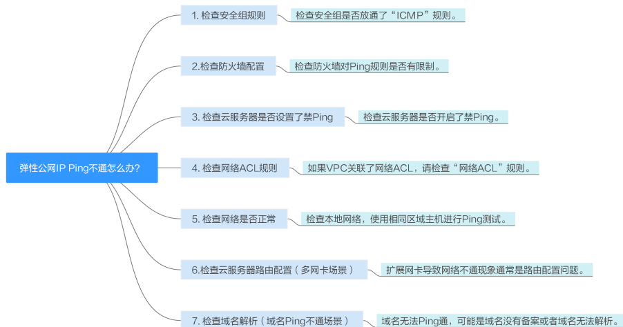
图 5-8 弹性公网 IP Ping 不通排查思路
