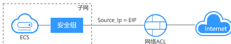
图 5-1 EIP 网络示意图
