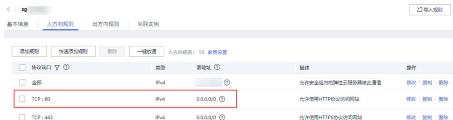
图 6-28 安全组 80 端口规则
