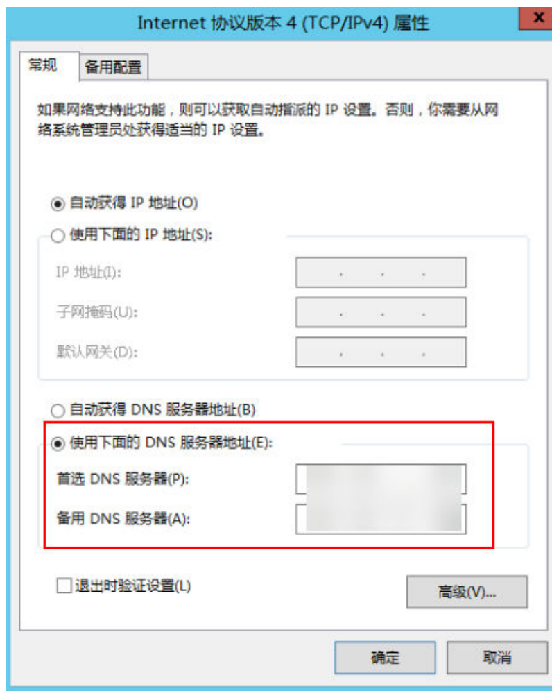
图 15-22 填写 DNS 服务器 IP 地址
