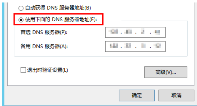
图 15-28 Windows 系统配置 DNS
