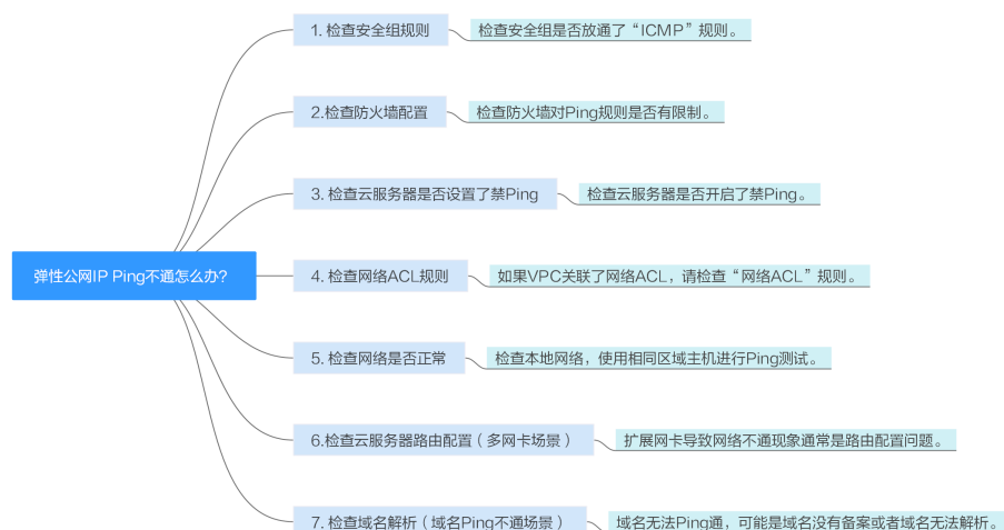
图 15-1 弹性公网 IP Ping 不通排查思路
