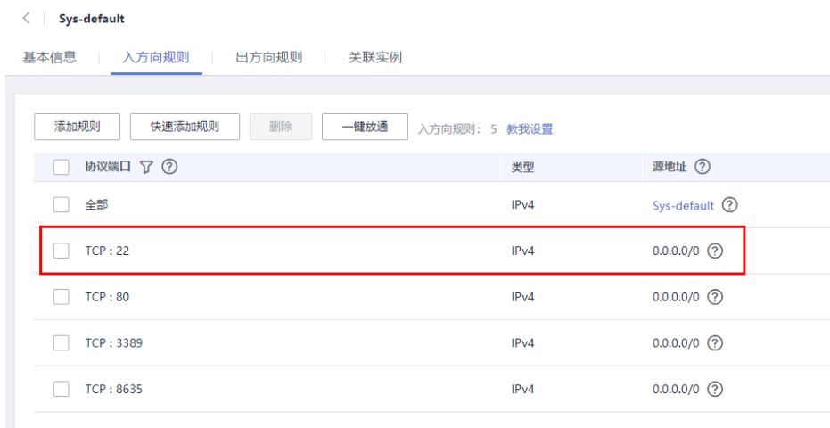
图 6-118 入方向开放 22 端口
