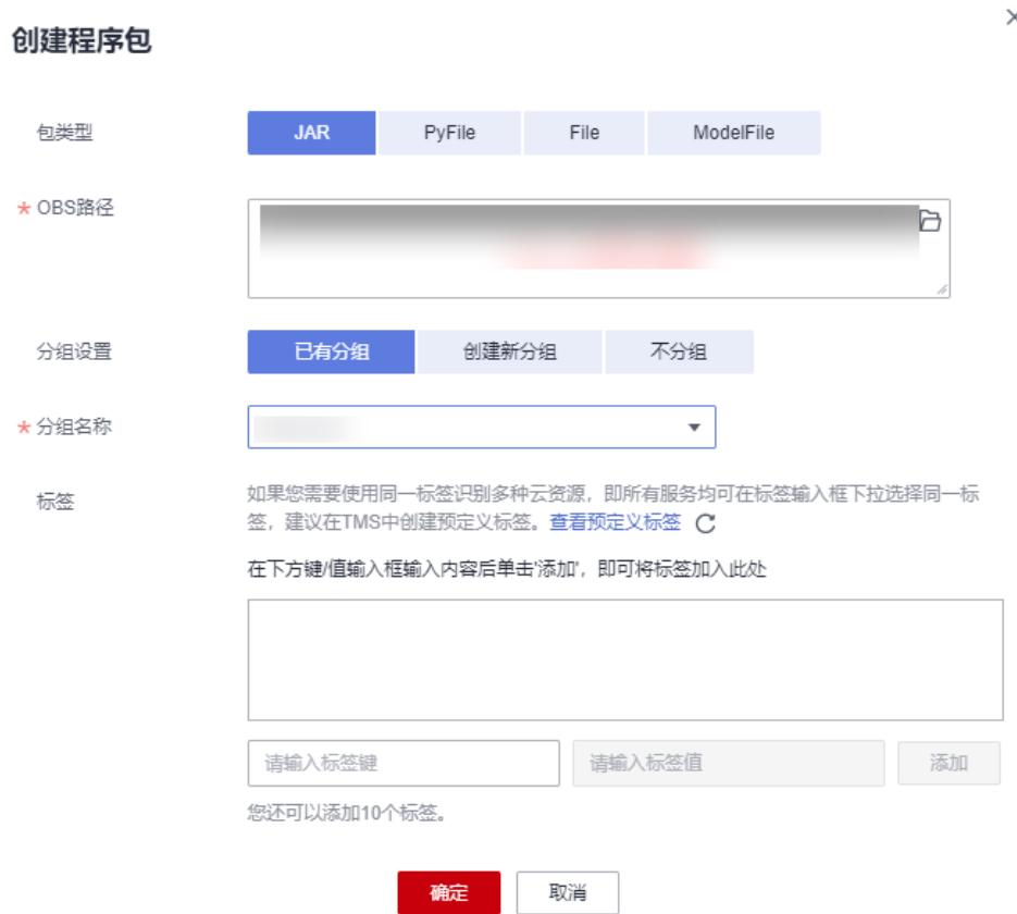
**步骤4** 在DLI控制台，打开“数据管理 > 程序包管理”，单击“创建”，创建 KafkaToKafka.properties对应的程序包。代码样例请参考
