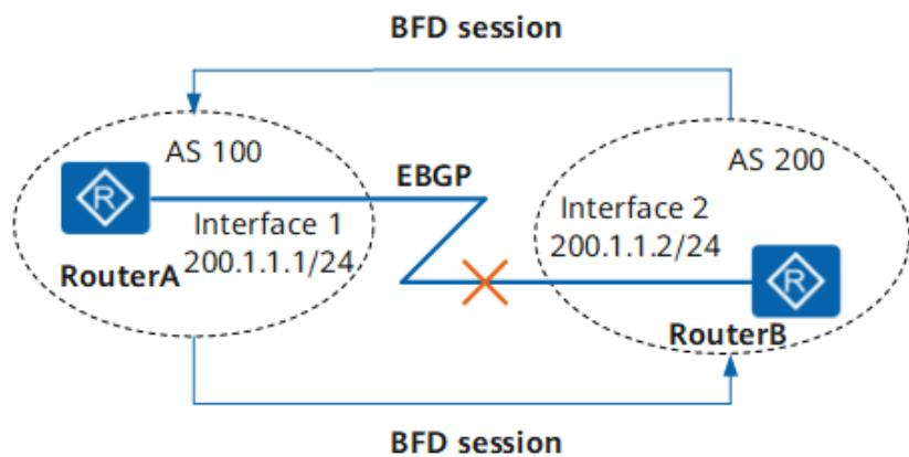
如图2-5所示，RouterA和RouterB分别属于AS100和AS200，两台路由器直接相连并建立EBGP连接。使用BFD检测RouterA和RouterB之间的BGP邻居关系，当RouterA和RouterB之间的链路发生故障时，BFD能够快速检测到故障并通告给BGP协议。
