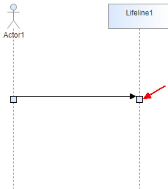
方式二：鼠标移至生命线直至元素四周出现蓝色三角，左键拉伸连线目标到生命线上，目标生命线变颜色后即可松开，弹出连线类型选择。
