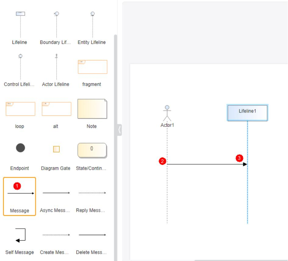
连线成功后生命线会自动生成激活块，手动无法拉伸长度，根据生命线消息线的发送/接收自动调节长度，可通过连线右键设置激活块的向上/向下延伸源端、结束源端/目标端激活块，提升/降低消息线层次。
