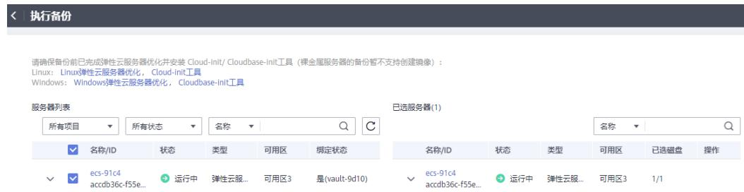
**步骤4** 在云备份的云服务器备份界面，在目标存储库中确认备份创建成功后，在“操作”列下选择“更多 > 复制”。如图1-8所示。备份将复制至华南-广州。
