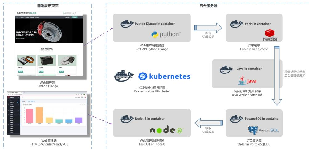
示例程序由表1-1中的5个可以独立开发、测试和部署的微服务组件构成。
