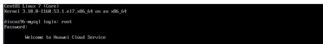
步骤3 输入命令mysql -u root -p指定root用户登录MySQL，输入后按回车键输入密码。使用SET PASSWORD修改密码命令格式为set password for root@'%' = password('新密码');
