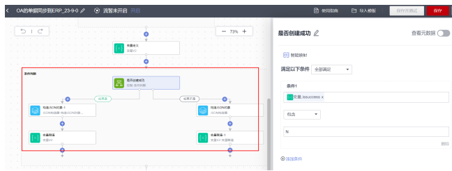
步骤8 用条件判断执行动作判断单据是否创建成功，并用json构造器构造响应体结构
