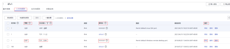
图 2-3 安全组高危端口策略设置
