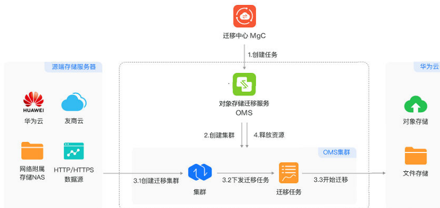
图 2-1 存储迁移逻辑架构图
