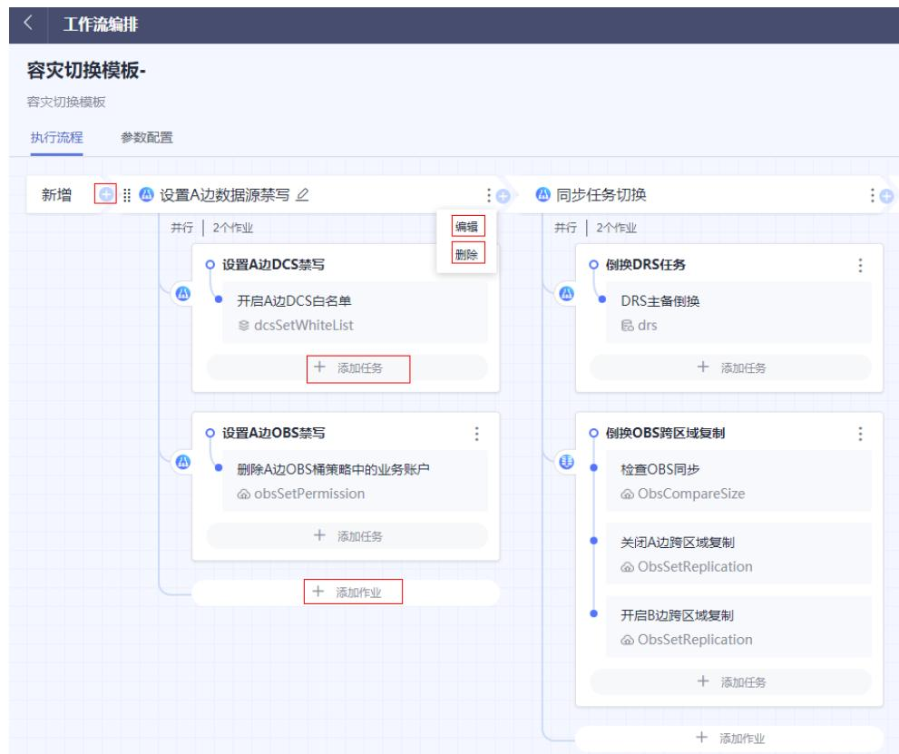
1. 新增阶段。单击新增阶段按键 ，在新增阶段弹窗中输入阶段信息，完成后单击“确定”。
