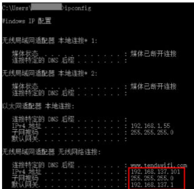
**步骤4** 打开浏览器，输入IPC摄像头的IP地址，将IPC摄像头IP地址更改成跟路由器同网段。
