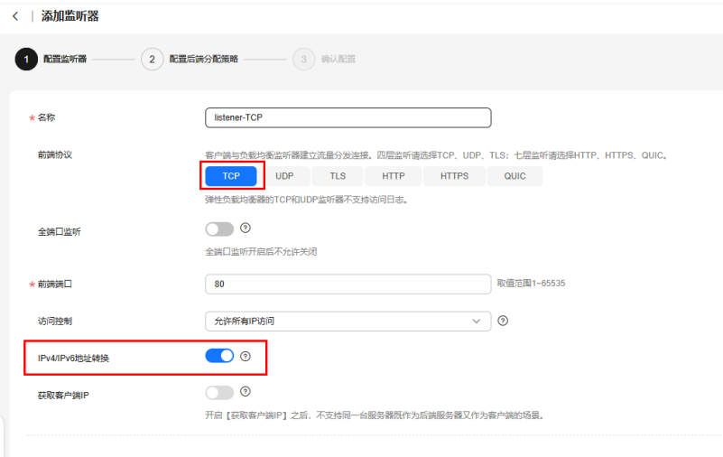
图 5-32 添加 TCP 监听器并开启“IPv4/IPv6 地址转换”
