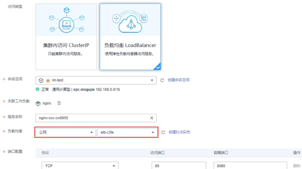
**步骤4** 单击“提交”，工作负载已添加“负载均衡 LoadBalancer”的服务。
