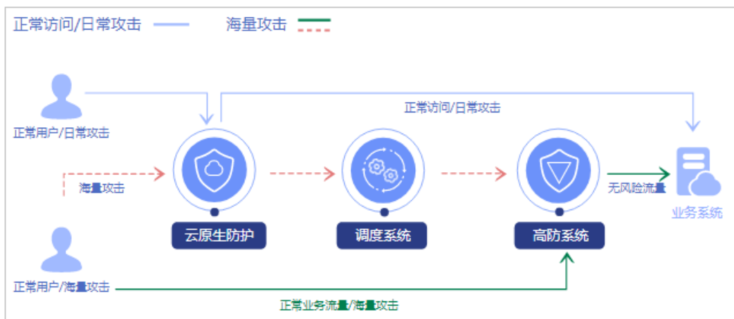
图 4-1 DDoS 阶梯调度工作原理
