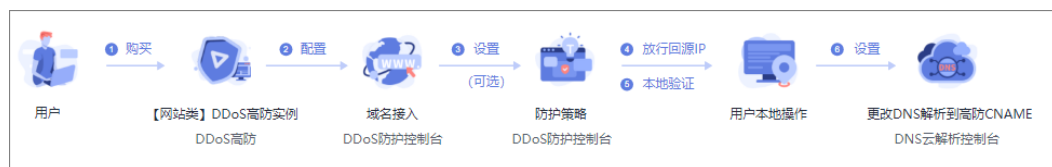
图 3-1 接入 DDoS 高防示意图
