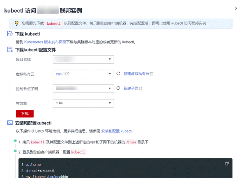
图 4-2 kubectl 连接联邦实例
