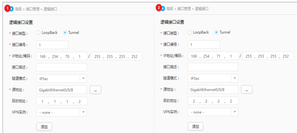
图 1-6 tunnel 接口配置
