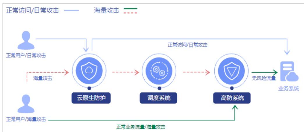
图 5-1 DDoS 阶梯调度工作原理
