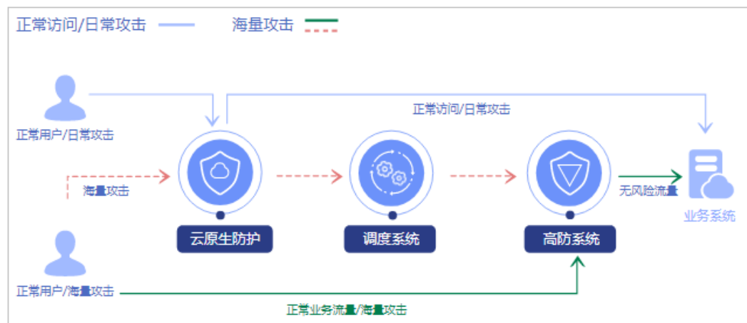
图 5-1 DDoS 阶梯调度工作原理
