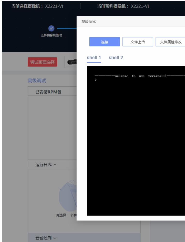
2. 单击“连接”，连接shell，可以分别选择shell1和shell2进行连接。
